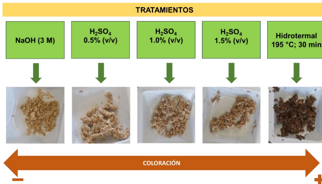
Figura 3. Tratamientos hidrotermales de izquierda a derecha: NaOH, H_2SO_4 (0.5 % v/v), H_2SO_4 (0.5 % v/v), H_2SO_4 (0.5 % v/v) e hidrotermal a 195 °C por 30 min.
