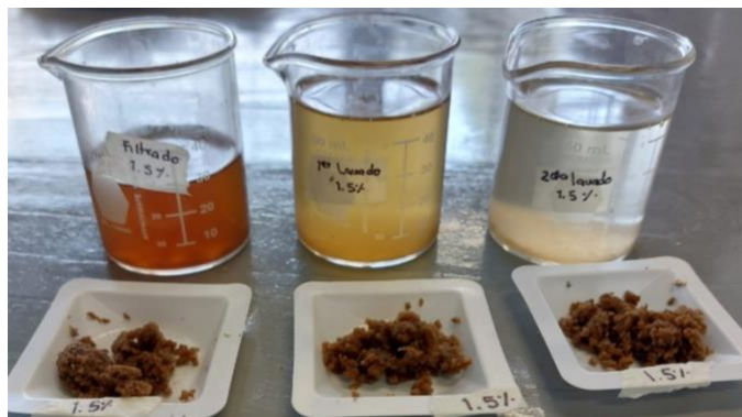
Figura 2. Filtrado y lavados de H_2SO_4 al 1.5%
