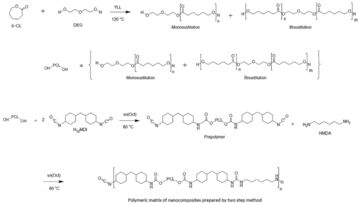
Figura 16. Ruta sintética de la preparación de PCL-diols y posterior síntesis de PU y PU sintetizado en dos pasos.
