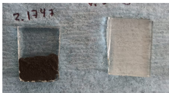
Figura 2. Comparación de electrodos FTO-ITO con y sin tinta conductiva (Graf-Graf 1 cm), respectivamente.
