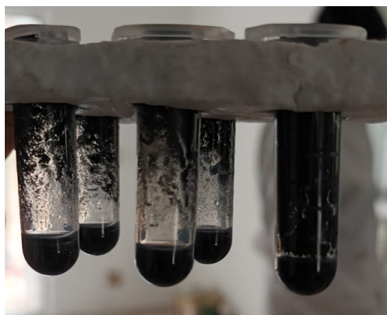
Figura 1. Tintas conductivas posterior a su preparación.
