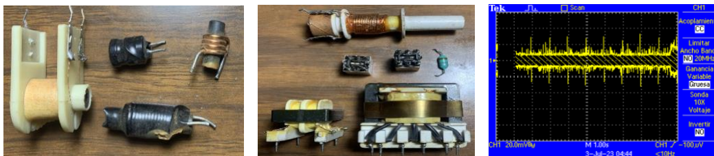
Figura 3. Diferentes tipos de inductores (imagen izquierda y central) para la detección de un pulso mostrado en la imagen del osciloscopio (imagen de la derecha).
