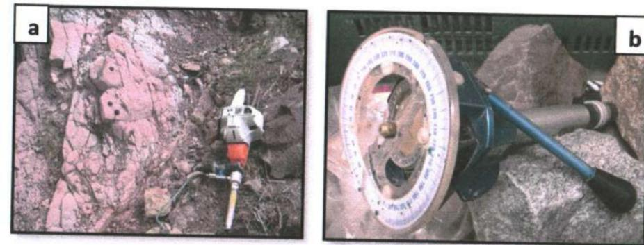
Fig. 3.1a Fotografía de Perforadora portátil con la cual se obtuvieron los núcleos; Fig 3.1b Fotografía del dispositivo orientador utilizado durante el presente trabajo.
