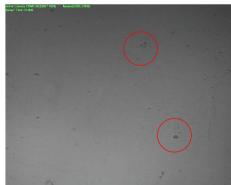
(b) Especímen fallado al 1 % de deformación sin generación de patrón cuadrícula.
