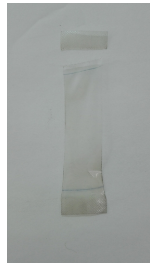
Figura 3.5 Prueba de rotura para bicapa: a) Curva \sigma - \epsilon , b) Muestra fallada.
