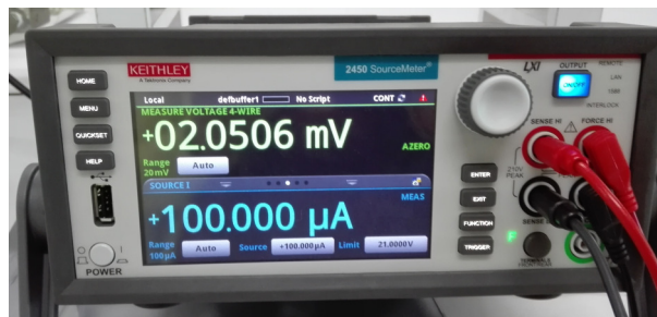
Figura 2.8 Fuente de potencial Keithley 2450.
