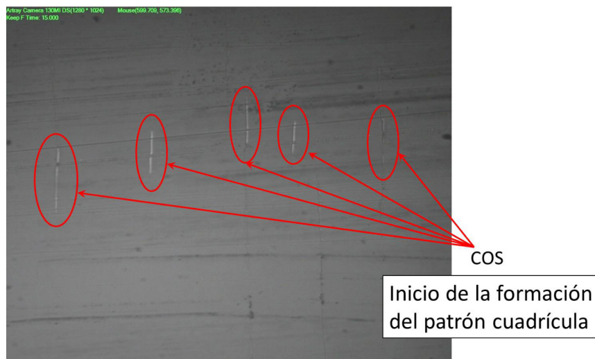
Figura 3.28 Micrografía de flexión a 3 puntos a las tricapas (P3HT-PCBM)/ITO/PET con separación de 25.4 mm y capa activa a compresión.
