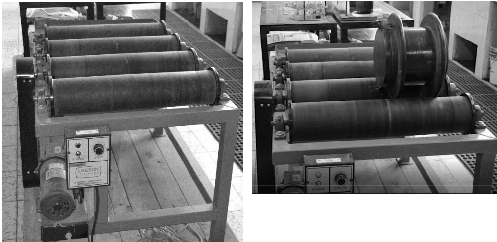
Figura 4.5.- Fotografías banco de rodillos para molino de bolas 8"x8".
