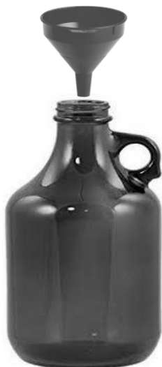
Figura 4.24.- Cianuración en botellas de vidrio o plástico, las primeras para lixiviación de finos o arenas, y las segundas pueden lixiviar partículas de hasta \frac{1}{4} ".
