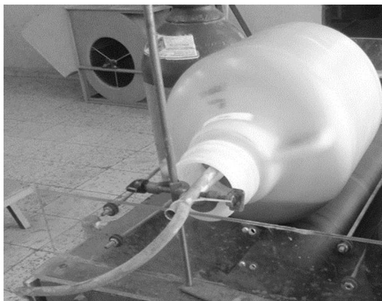
Figura 4.24.- Cianuración en botellas de vidrio o plástico, las primeras para lixiviación de finos o arenas, y las segundas pueden lixiviar partículas de hasta \frac{1}{4} ".
