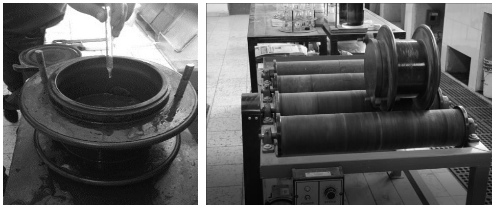
Figura 4.17.- Adición de reactivos y molienda de muestras: 400 g \text{ZnSO}_4 /Ton, 30 g A-31/Ton, 600 mL \text{H}_2\text{O} y molino de 8"×8".
