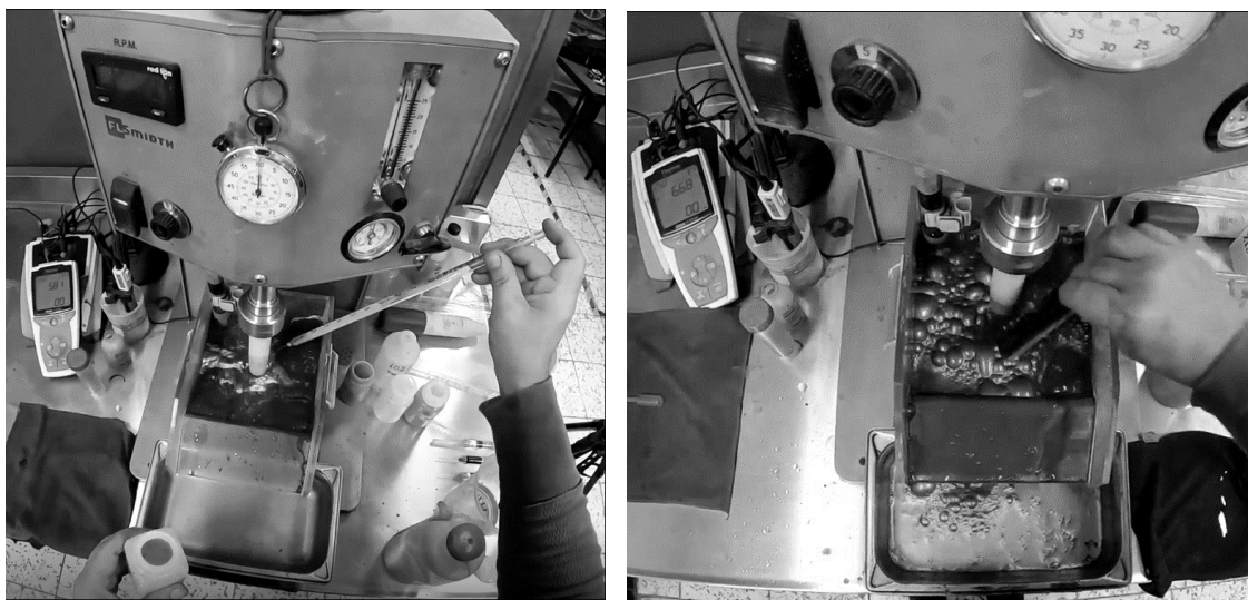
Figura 4.18.- Fotografías mostrando una flotación colectiva pirita-arsenopirita- oro.
