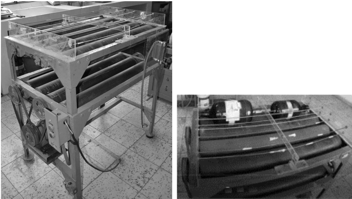
Figura 4.3.- Fotografía mostrando detalles del sistema de lixiviación dinámica en botellas-banco de agitación.
