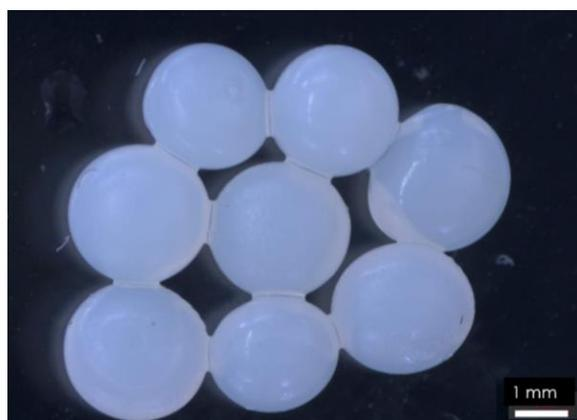
**Figura 4.1.** Microcápsulas sin reticular, sin líquido iónico (MC0. dp: 2.34 mm)
