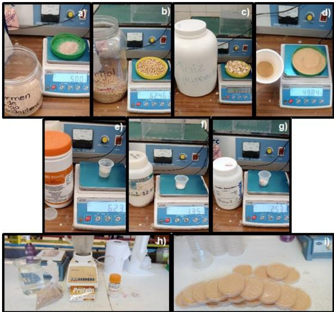
Figura. 10. Pesaje de ingredientes y elaboración de dieta para alimentación y mantenimiento de colonia S. frugiperda . Enumeración a) Medición de masa de germen de trigo, b) Medición de masa de frijol, c) Medición de masa de granos de maíz, d) Medición de masa de agar bacteriológico, e) Medición de masa de levadura, f) Medición de masa de ácido sórbico, g) Medición de masa de ácido ascórbico, h) Mezcla de ingredientes sólidos con ADE caliente para mejorar función del agar, levadura, formaldehído y antibiótico, i) Dispersión de dieta elaborada en vasos individuales y cajas Petri para su solidificación y conservación.
