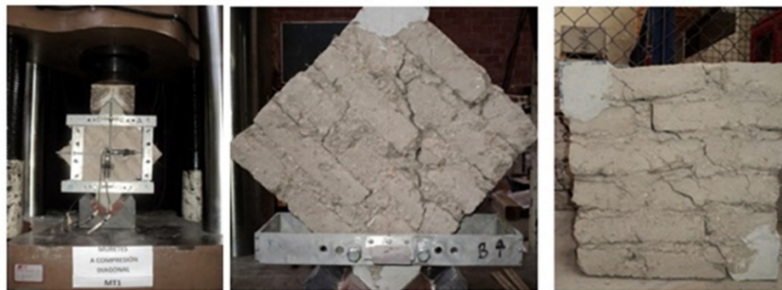
Figura 7. Ensayo de muretes. Fuente: Elaboración propia.
