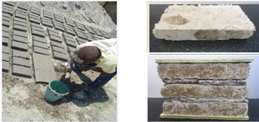
Figura 3. Elaboración de piezas de adobe escaladas (Izquierda) y piezas trasladadas al laboratorio de estructuras y materiales de la Universidad de Guanajuato Campus Celaya-Salvatierra (Derecha).
