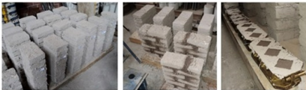
Figura 4. Especímenes de adobe: pilas (Izquierda), muretes (Centro) y cubos de mortero (Derecha).
