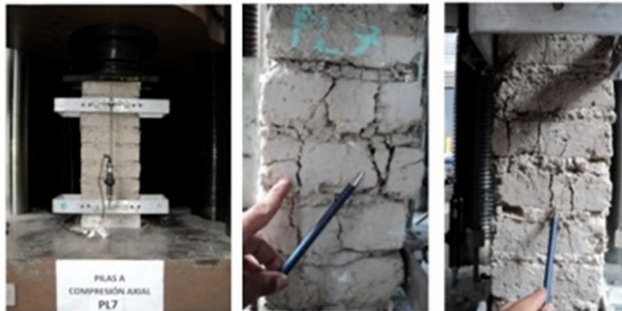
Figura 5. Ensayo de pila y falla del espécimen.
