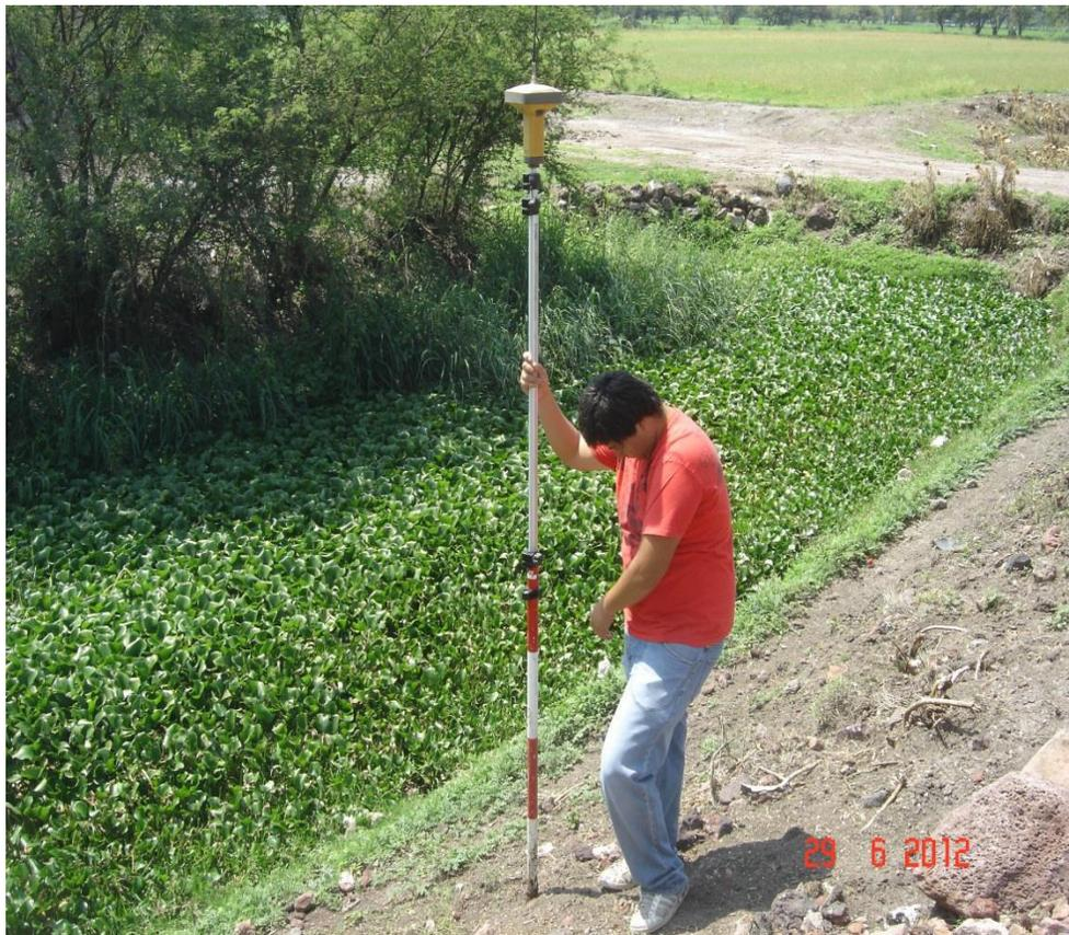
Imagen 3.4.- Otras vistas del procedimiento del levantamiento con GPS diferencial
