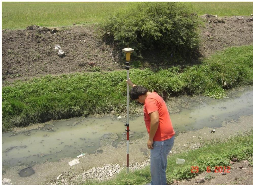
Imagen 3.3.- Vistas del procedimiento del levantamiento con GPS diferencial
