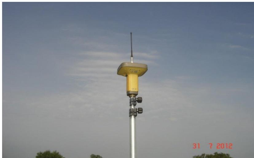
Imagen 3.2.- Vista del receptor móvil
