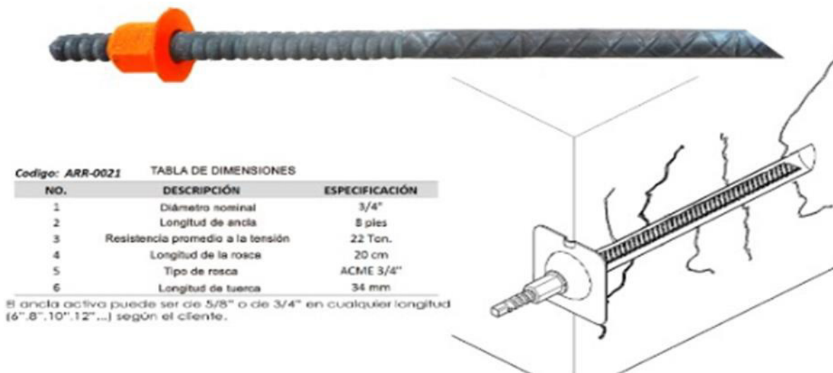
Figura 13.- Muestra el ancla a utilizar y su accionar.
