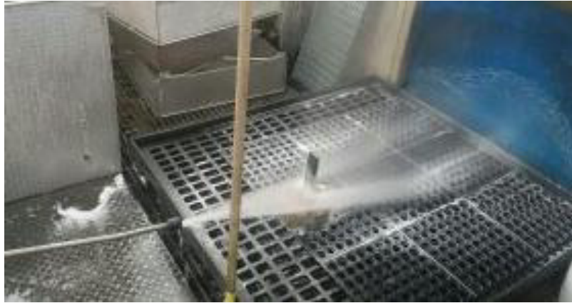
Figura 10.- Limpieza con agua abaja presión aplicado manualmente [fuente propia]
