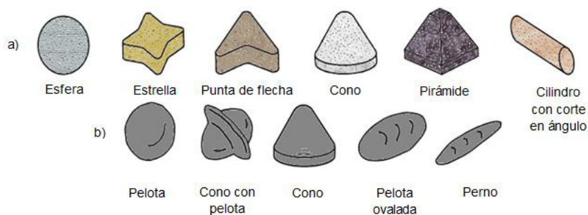
Figura 7.- Formas y figuras de abrasivos a) medios abrasivos convencionales, b) formas de acero para pulido [17].
