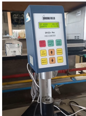
Figura 3. Determinación de la viscosidad del aceite de freído de alitas de pollo (soya/sebo de res).
