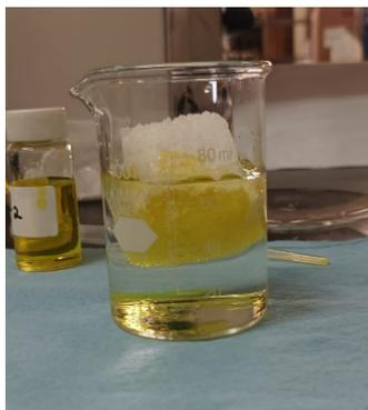
Figura 7. Esponja, elaborada con template de azúcar refinada-sal 50:50, flotando al término de la prueba de remoción de diclorometano.
