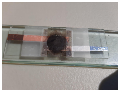
Figura 10. Celda fotovoltaica de melanina con electrodos de cobre y aluminio.
