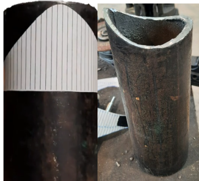
Figura 10. Tubo injerto con plantilla (lado izquierdo) y tubo injerto cortado (lado derecho).
