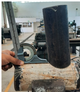
Figura 11. Comprobación del ángulo de inclinación del tubo injertado excéntricamente a 83 grados.
