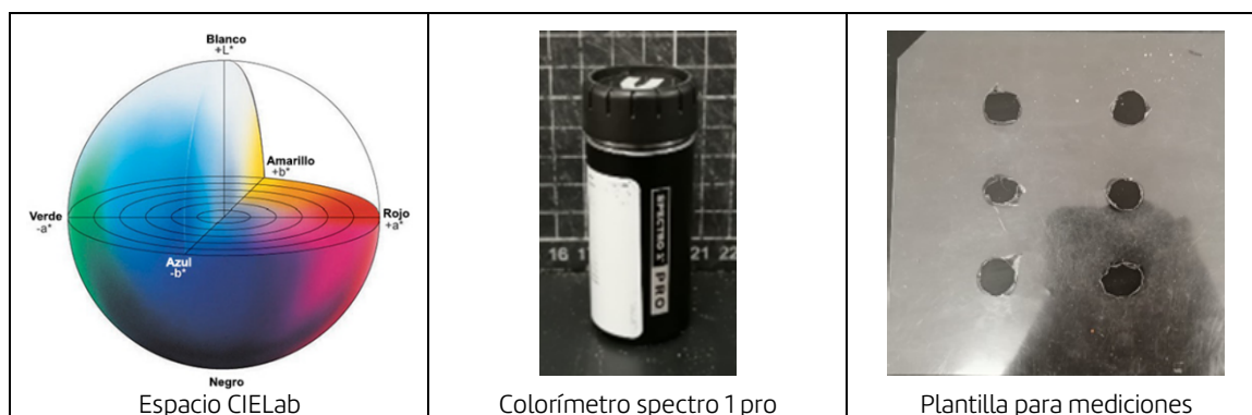
Figura 7. Espacio CIELab, fotografía del colorímetro y plantilla para realizar mediciones
