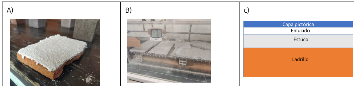
Figura 5. a) placas de barro con estuco, b) fraguado controlado del estuco sobre barro, c) capas que componen el estuco pigmentado
