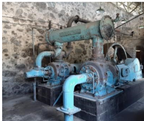
Figura. Compresor de aire de dos etapas en Mineral de Valenciana, tomada de www.google.com 10
