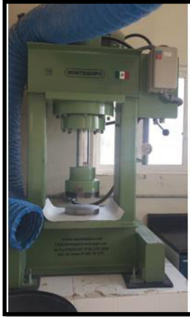
Figura 11. Prensa de trituración utilizada.
