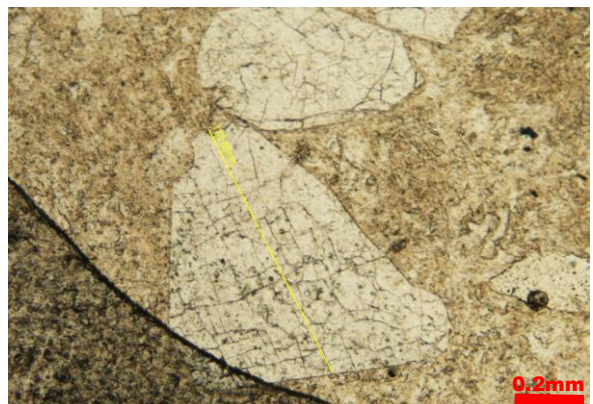
Cristal mas grande encontrado en esta lamina delgada con un largo de 0.83mm
