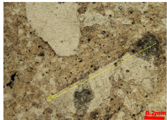
Cristal mas grande encontrado en esta lamina delgada con un largo de 1.3mm
