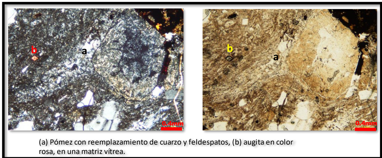
Figura 35. Fotomicrografías de la lámina SA66-2, a la izquierda con nicoles cruzados y a la derecha con luz paralela.
