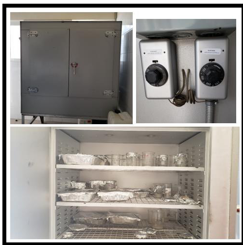
Figura 10. Horno de secado con muestras dentro.
