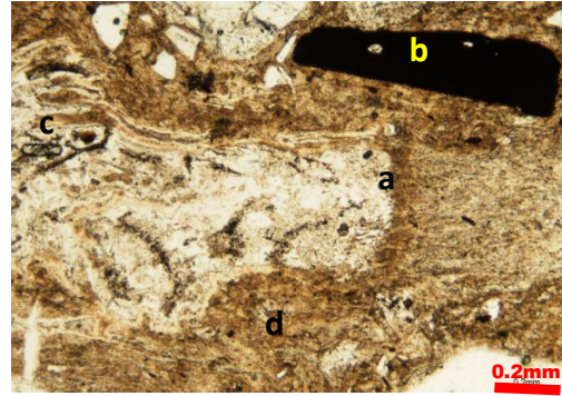
(a) Pómez siendo reemplazada por cuarzo, feldespatos potásicos. (b) Piroxeno muy alterado. (c)Circón, en un (d) matriz vítrea.
