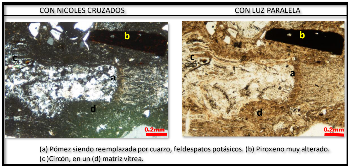
Figura 38. Fotomicrografías de la lámina SA67-8.
