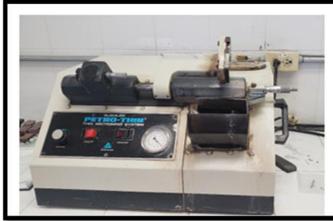
Figura 6. Equipo Petro-Thin para desbastar las láminas delgadas hasta 60 micras.
