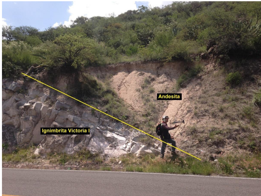
Figura 25. Afloramiento del punto #21 de la sección El Salto, contacto entre andesita e ignimbrita Victoria I.
