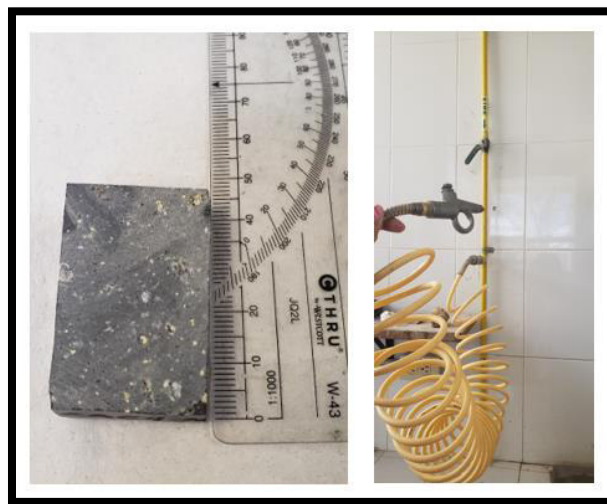
Figura 3. Galleta ya cortada, limpia y secada por el soplete de aire comprimido.
