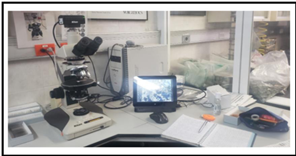
Figura 8. Equipo utilizado para el análisis petrográfico y para obtención de fotografías.
