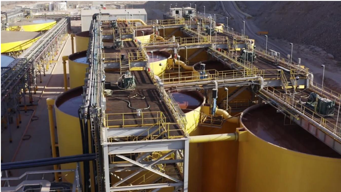
Imagen 6. Reactores con agitación para el proceso de lixiviación.
