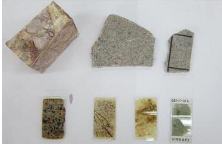
*Figura 3.2 Ejemplo de lámina delgada empleadas en el análisis petrográfico [19].*
