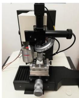
*Figura 5.4. Instrumento CSM de ensayos de Nanoindentación.*
