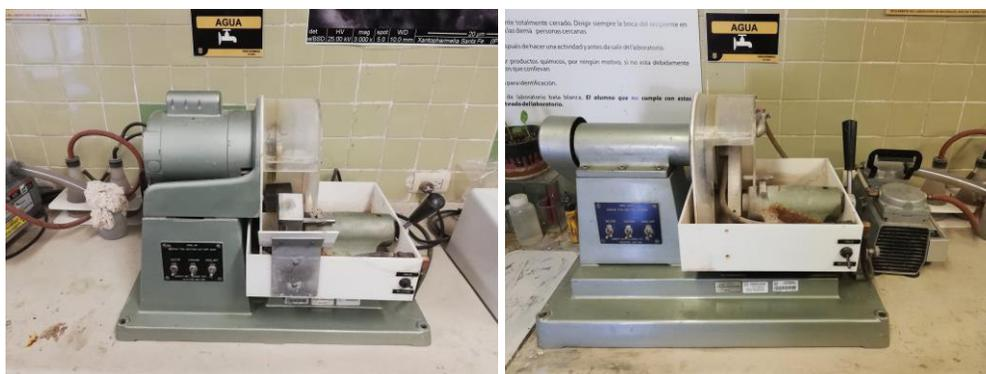
*Figura 5.5. Maquina cortadora y pulidora GMW de láminas delgadas.*
