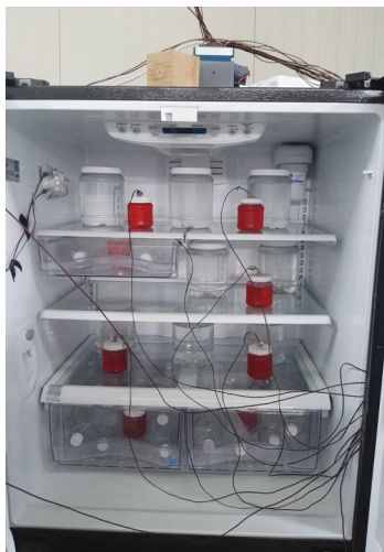
IMAGEN 2: Distribución de cargas y termopares.
