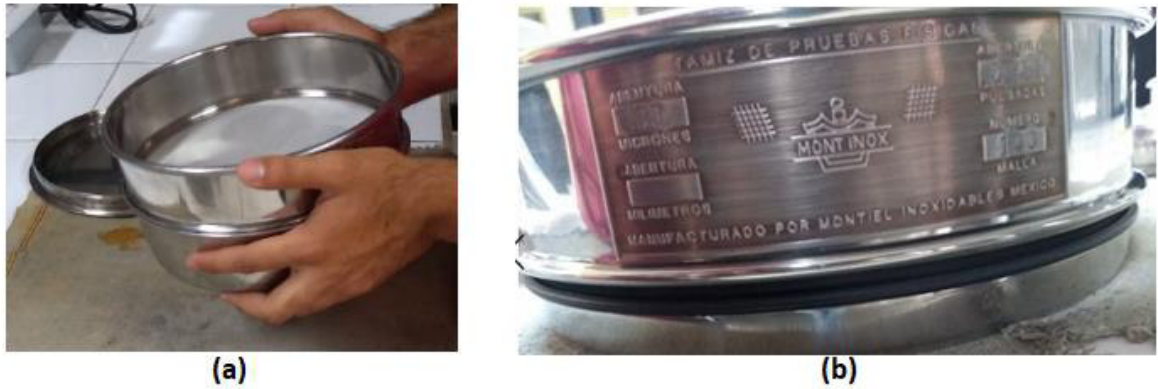
Fig. 3.9. Proceso de tamizado de partículas con la malla #140.
