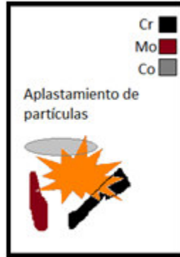
Fig.2.7. Deformación de las partículas a causa del impacto.
