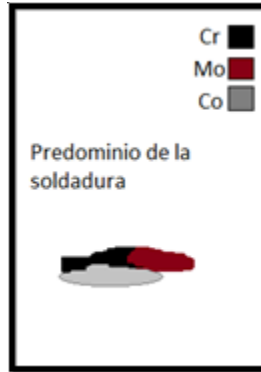
Fig.2.8. Comienza el proceso de fractura y soldadura de las partículas.
