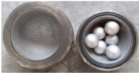
Fig.3.8. Bolas de acero AISI 1080 endurecidas.
