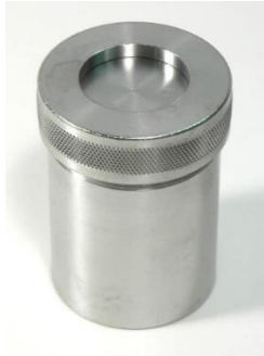
Fig.3.7. Vial o recipiente utilizado para cargar la materia prima y llevar acabo la aleación.
