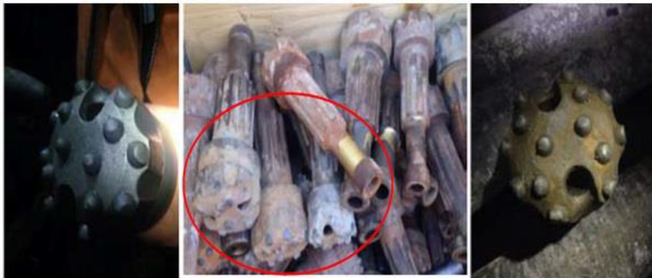
Figura 23. Ejemplos de presiones de avance y rotación excesivas.
