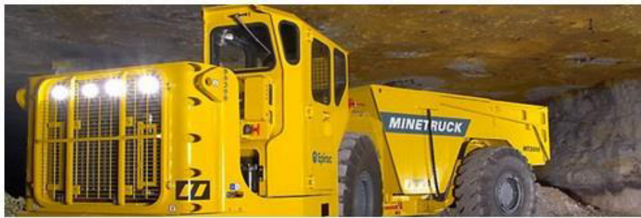
Figura 36. Camión de bajo perfil MT 2010 utilizado en área para el acarreo a tolvas de mineral
