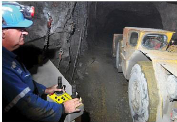
Figura 37. Operador de scoop tram rezagando con control remoto
