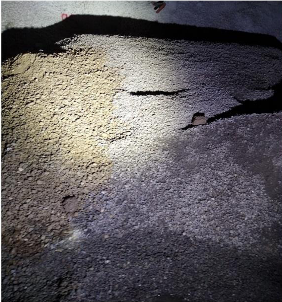
Figura 34. Material inerte utilizado para tapan el barreno después de cargado (taco).
