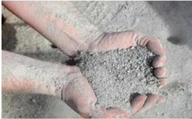
Figura 24. Una velocidad de rotación adecuada, generará fragmentos de roca (detritos) de mayor dimensión.
