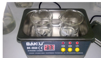
IMAGEN 3: Limpieza ultrasónica de las muestras de aleación de magnesio AZ31.
