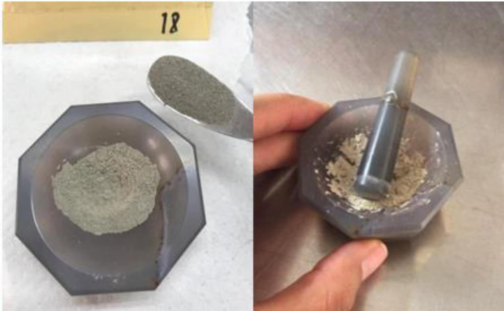
Figura 24. Molienda de la muestra para cumplir con los requisitos de prueba de fluorescencia por rayos X.
