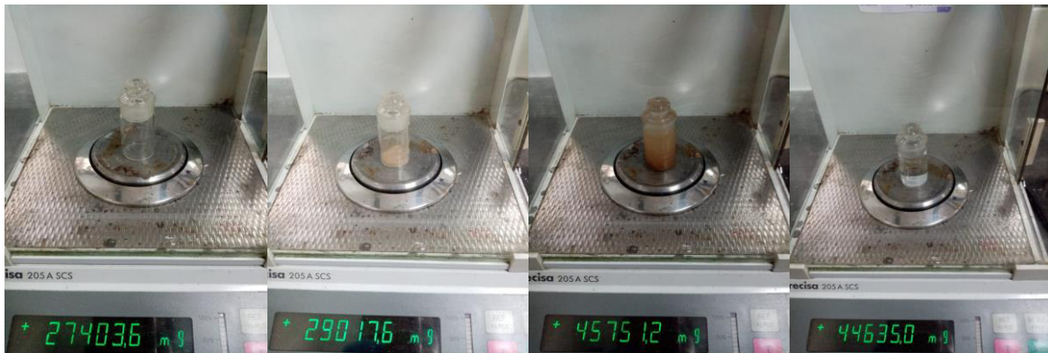
Figura 25. Determinación de la gravedad específica de las muestras, toma de pesos "A", "M", "S" y "P".
