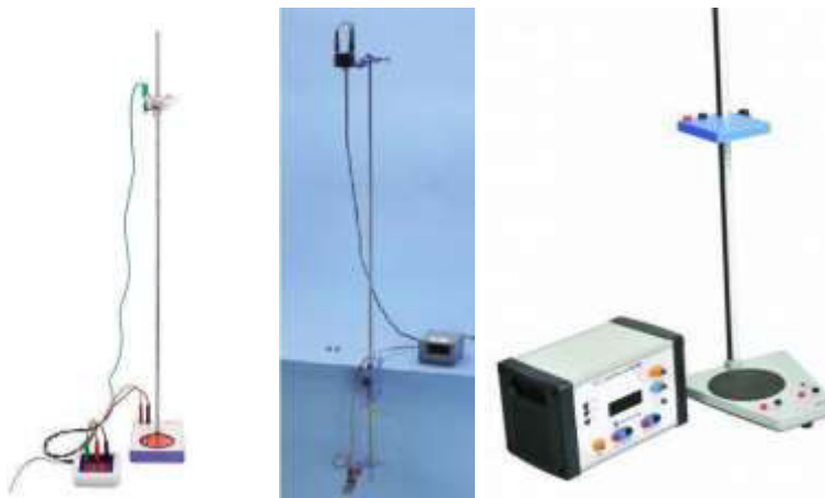
Figura 1- Aparatos de caída libre de la marca a) 3B Scientific [8], b) I.C.T., S.L [9]. y c) IBD+Ciencia [10].
