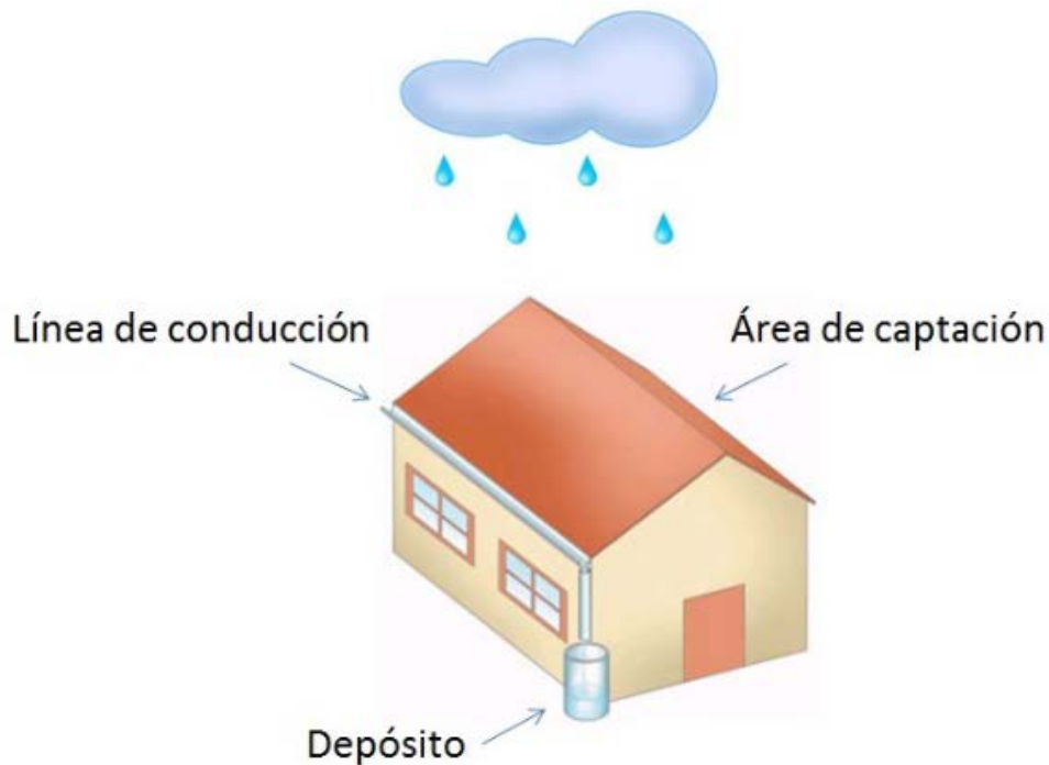
Figura 3. Componentes principales de un sistema de captación de agua de lluvia utilizados en el proyecto realizado por ACAUG en la comunidad Presa del Gato del municipio de Dr. Mora, Gto.
