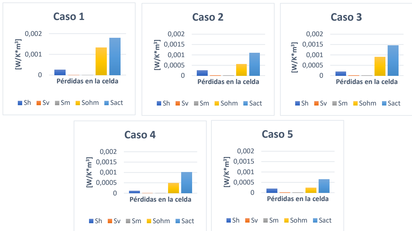
IMAGEN 2: Pérdidas en la celda de combustible para cada conjunto de temperaturas.
