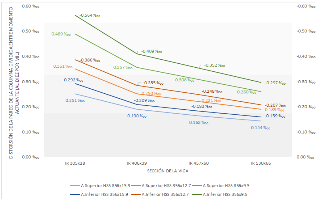
FIGURA 4.18: Distorsiones relativas en la pared de la columna de los modelos con columnas de 356mm. de diámetro
