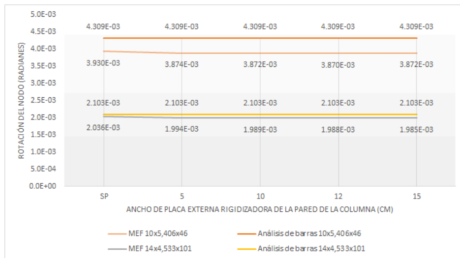
FIGURA 4.2: Comparación de rotaciones en modelos con placa rigidizante de ancho variable
