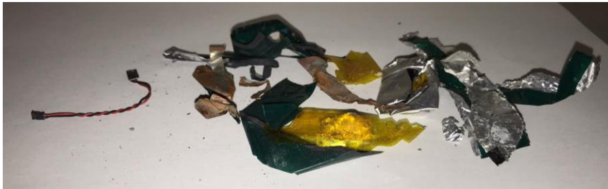
Ilustración 3.1 Carcasa de la batería desprendida mecánicamente.
