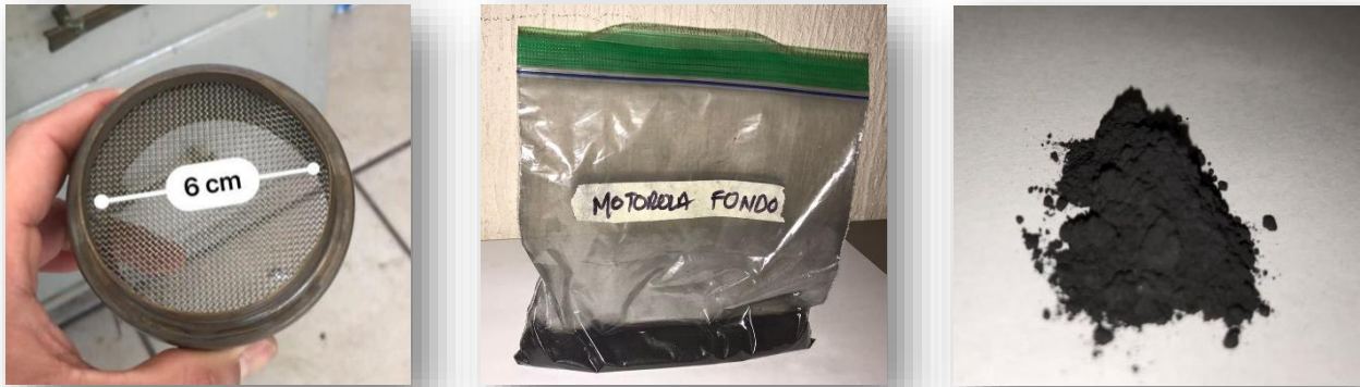
Ilustración 3.3 Proceso de tamizado y polvo fino de cobalto obtenido.
