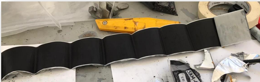
Ilustración 3.2 Cinta desenrollada del núcleo de la batería.
