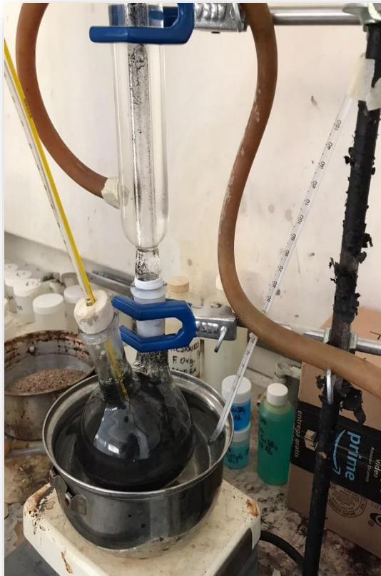
Ilustración 3.4 Proceso de lixiviación y filtrado de la solución concentrada.
