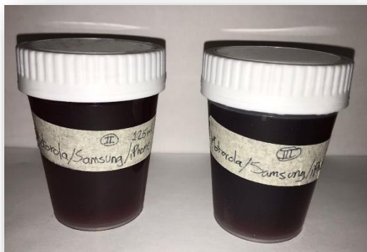
Ilustración 4.6 Concentrado producto de la lixiviación con ácido sulfúrico. Filtrado.
