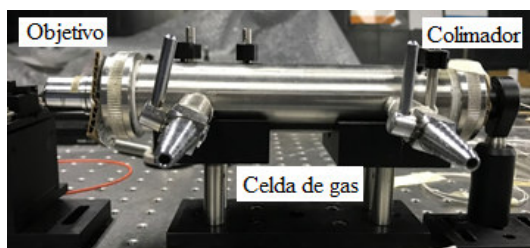
Figura 4.6: Celda de Gas.
