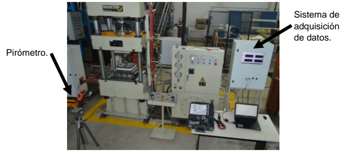
IMAGEN 3: Sistema de adquisición de variables.
