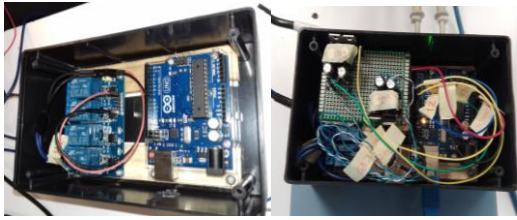
a) b) Figura 6. Proceso de conexión del Arduino para comunicación entre robot y el VI: a) Inicio. b) Resultado final.
