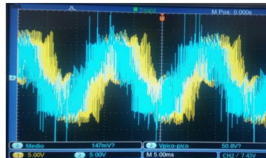
Figura 6: Voltaje en dos de las fases de salida de la VSI sin filtrar.
