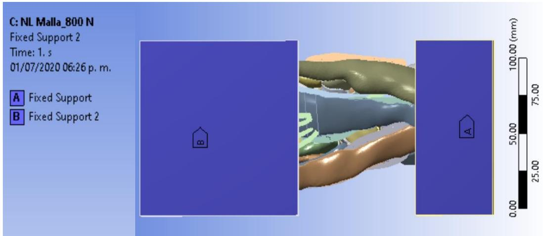
Fig. 3.34. Soporte fijo aplicado a superficies de la plataforma para restringir su movimiento en todas las direcciones.
