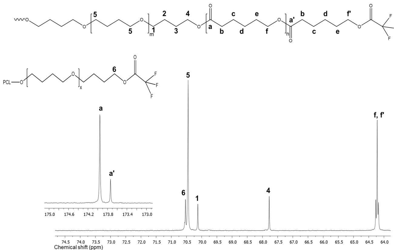
**Figura 7.5** Espectro RMN <sup>13</sup>C (100 MHz) de PCL-PTHF<sub>650</sub>-PCL<sub>10</sub> (DP=10) en CDCl<sub>3</sub> derivatizado con TFAA a temperatura ambiente.
