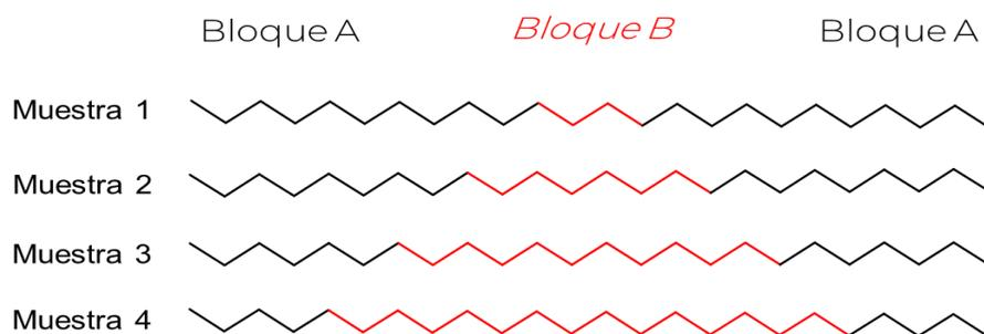
**Figura 4.1** Ilustración para ejemplificar un crecimiento del Bloque B para diferentes especies de copolímeros tribloque con la misma longitud en la cadena principal.
