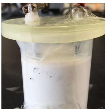
Figura 22. Proceso electroforético para depositar el TiO 2 sobre el BDD
