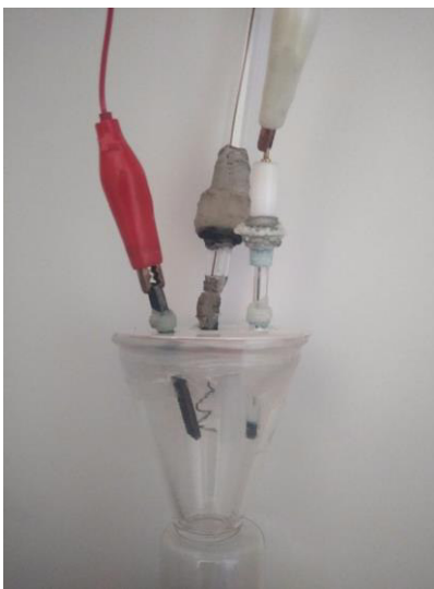
Figura 14. Sistema típico de 3 electrodos para estudios de microelectrolisis.
