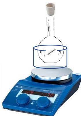
Esquema 17. Imagen general de como montamos la reacción para llevar a cabo la polimerización de la L-LA.
