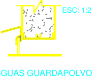
BOTAGUAS GUARDAPOLVO PUERTAS P-1 Y P-4 BOTAGUAS GUARDAPOLVO, AJUSTABLE A POSICIÓN P-1, COLOR SIMILAR A ENTREPAÑOS P-4, COLOR BLANCO O SIMILAR
