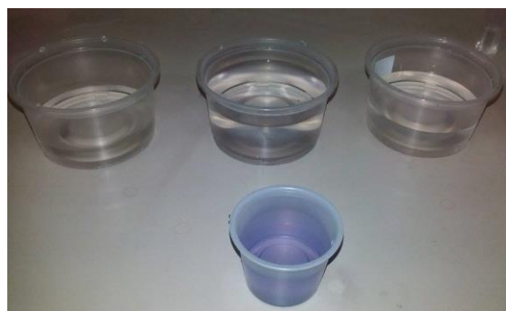
Figura 2. Muestra sintética de azul mezclilla. Antes y después de la experimentación (10 horas) para los tres catalizadores empezando de izquierda a derecha: \text{TiO}_2 , Zn y Fe.
