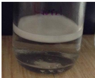
IMAGEN 1: Separación de fases de emulsión empleando Lauril éter sulfato de sodio como tensoactivo.
