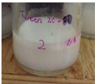
IMAGEN 2: Emulsión con escasa separación de fases empleando tween.
