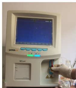
IMAGEN 2: Presentación de la muestra a la sonda del analizador hematológico.
