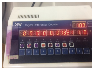
IMAGEN 4: contador digital utilizado para el diferencial de leucocitos.
