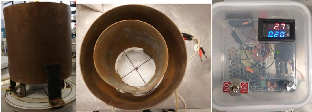
**Figura 3 Electrodo de hierro para electrocoagulación de arsénico y regulador de amperaje (diseñado y elaborado por el Dr. César Álvarez Mejía).**
