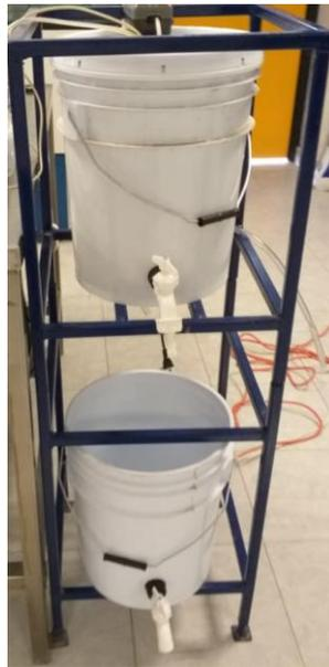
**Figura 2 Soporte y contenedores cilíndricos del sistema de EC**
