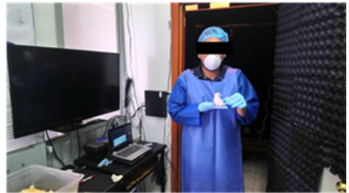
**Figura 3.** Unidad de Conducta. Computadora con programa Ethovision XT, sistema de video circuito cerrado, pantalla de visualización y equipo de protección tanto para el espécimen como para el investigador, así como cuarto aislado de ruido y con ambiente controlado.
