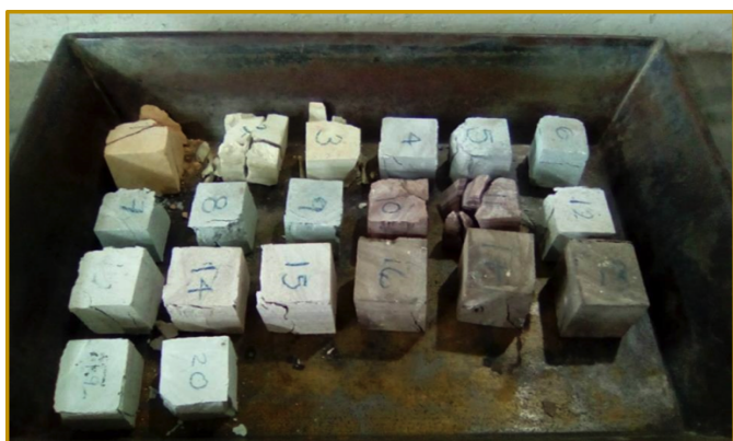
Imagen 7. Muestras de cantera, posteriores a la prueba GRUPO B. Fuente: Elaboración propia.
