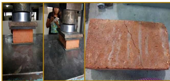
Imagen 8. Prueba de compresión simple del tabique de barro rojo recocido. Fuente: Elaboración propia.
