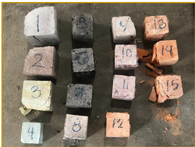
Imagen 6. Muestras de cantera, posteriores a la prueba GRUPO A. Fuente: Elaboración propia.
