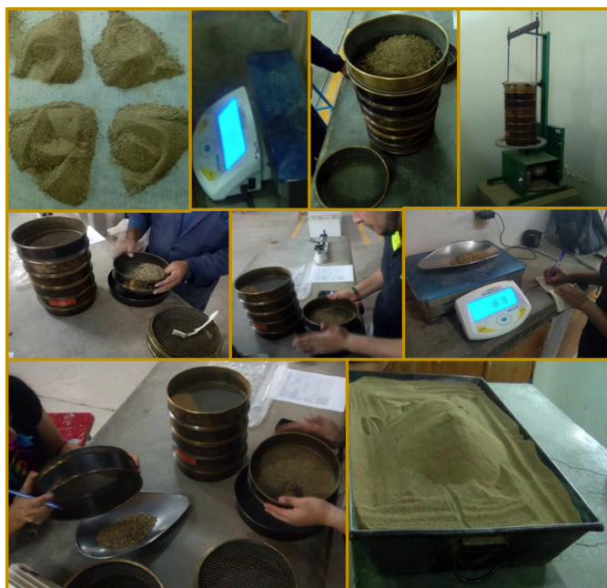
Imagen 1. Proceso de granulometría de arena. Fuente: Elaboración propia.
