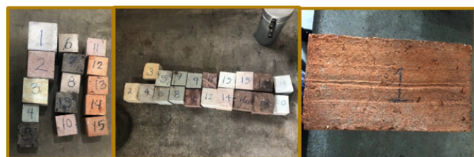
Imagen 3. Muestras de cantera y tabique de barro rojo recocido. Fuente: Elaboración propia.
