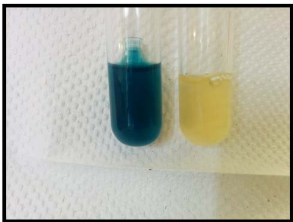
Imagen 2. Presencia de color para la detección de arsénico, en 2 mL de muestra.
