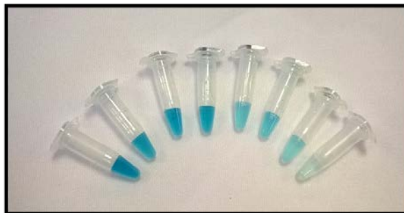
Imagen 3. Detección de arsénico a través del desarrollo de color en presencia de arsénico, en 100 \mu L de muestra.
