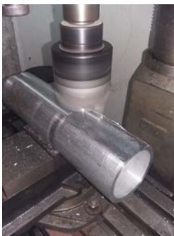
IMAGEN 5: En esta imagen se aprecia otro cilindro siendo debastado en una fresadora convencional, ya que de este cilindro se ocupó hacer unos maquinados en sus bordes.
