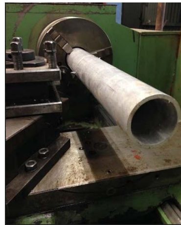
IMAGEN 2: En esta imagen se puede apreciar un tubo de aluminio siendo cortado por una cuchilla en un torno.
