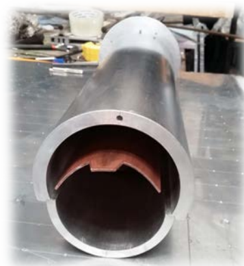
IMAGEN 8: En esta imagen se muestra el "BPM" finalizado. Se ha quitado una de sus tapas laterales para mostrar el interior.
