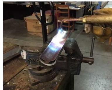
IMAGEN 7: Se puede apreciar que se calienta la pieza de cobre de la Imagen 5 para poder darle la curvatura requerida.
