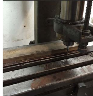
IMAGEN 6: En esta imagen se muestra un bloque de cobre siendo maquinado en una fresadora convencional, esta pieza de cobre será la placa electrodo del "BPM".
