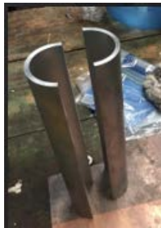
IMAGEN 4: Se aprecia las mitades obtenidas del corte del cilindro de la imagen 3.
