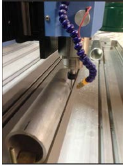
IMAGEN 3: El cilindro (en su longitud final) siendo cortado longitudinalmente en la cortadora CNC para obtener la mitad del cilindro requerida.
