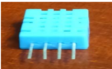
Imagen 3. Sensor DHT11. Sensor para medir la temperatura
